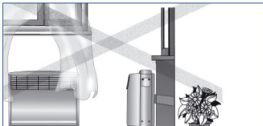
> Sopra: installazione condizionatore montaggio scorretto > sotto: montaggio corretto.
